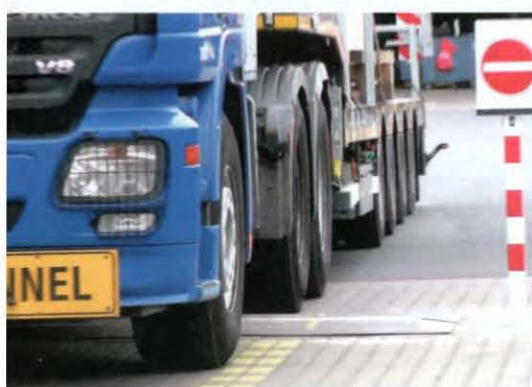
Markierungen: Der richtige Winkel, in dem die LKW die unterschiedlichen Reifenprüfsysteme überqueren, ist wichtig – sonst werden die Werte verfälscht
