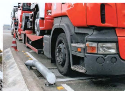
Markierungen: Der richtige Winkel, in dem die LKW die unterschiedlichen Reifenprüfsysteme überqueren, ist wichtig – sonst werden die Werte verfälscht
