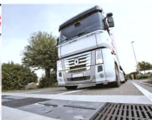
Markierungen: Der richtige Winkel, in dem die LKW die unterschiedlichen Reifenprüfsysteme überqueren, ist wichtig – sonst werden die Werte verfälscht
