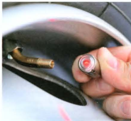
Leuchtende Diode: Der Reifen braucht mehr Luft
