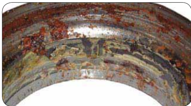
Beispielfelder eines Wassereintritts in ein HBU1-Lager (typische Bilder – nicht VKBA 3496)
