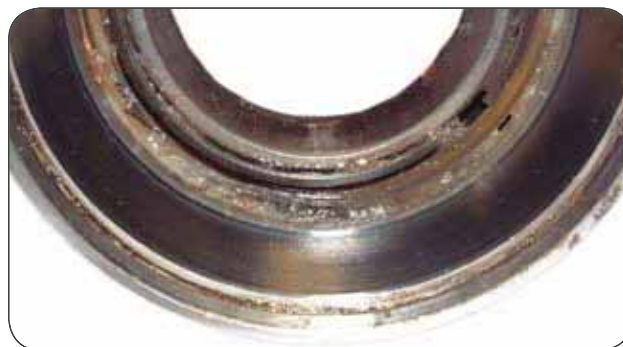
Beispielfelder eines Wassereintritts in ein HBU1-Lager (typische Bilder – nicht VKBA 3496)
